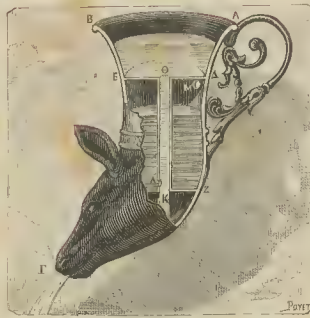
Fig. 1.—Vasija de Heron, por la que sale agua ó vino á beneplácito
